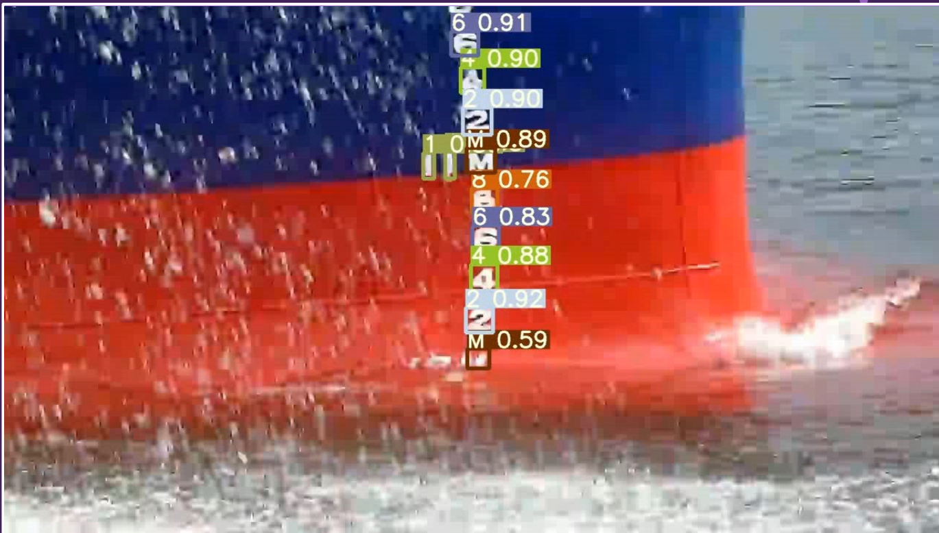
Детекция и идентификация цифр марки углубления с помощью нейронной сети YOLOv5
