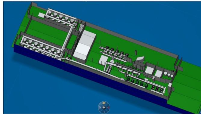
Реконструкция морозильной рыбоперерабатывающей плавбазы под выпуск консервов производительностью 500 банок в минуту с автоматическим автоклавным отделением
