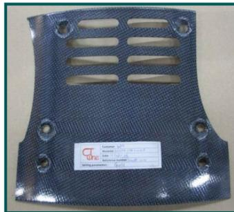
**Термоформование термопластичных ПКМ**
