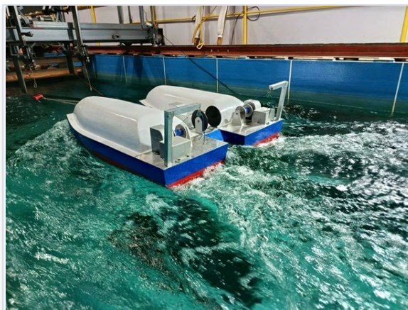
Модель промыслового катамарана (КГТУ) в гидроканале «Фишеринг сервис»
