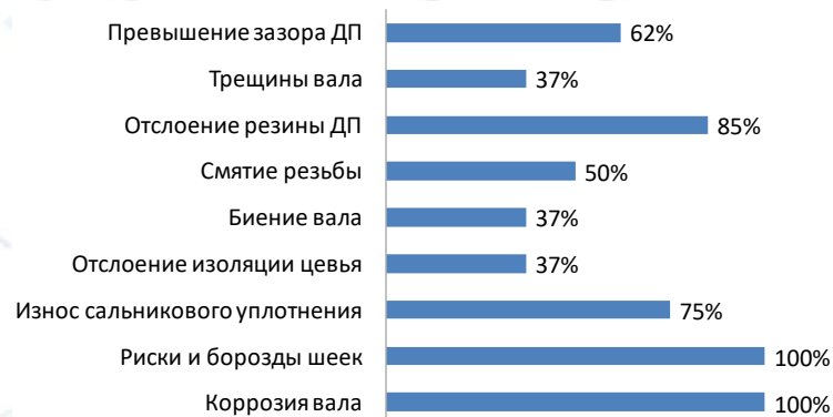
Дефекты, выявленные при ремонтах
